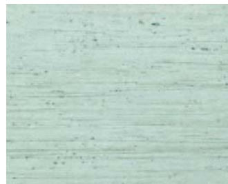
マニーハードファイバーステンレス組織 Structure of MANI hard fiber stainless steel
